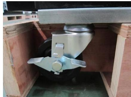
La rueda tiene un freno. Girándolo de un lado a otro se bloquea y desbloquea la rueda.
